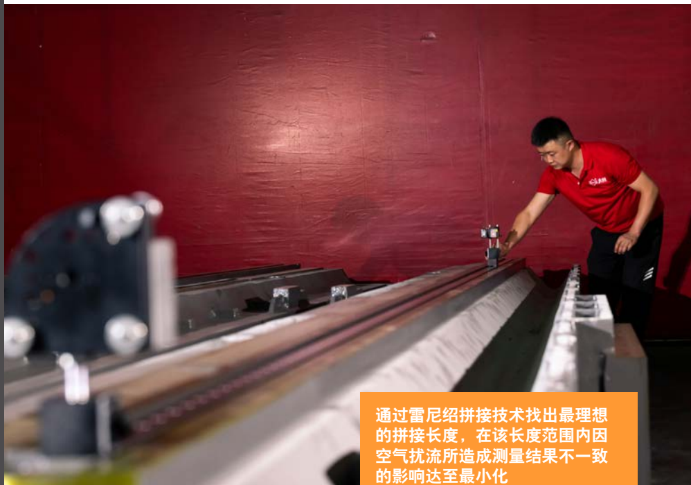
雷尼绍XK10校准仪采用激光测量原理，在进行长行程检测时展现了其优势
