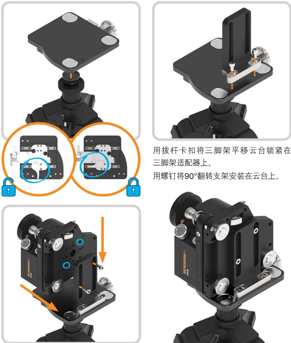
用螺钉将发射器紧靠90°翻转支架安装在三脚架平移云台上。
