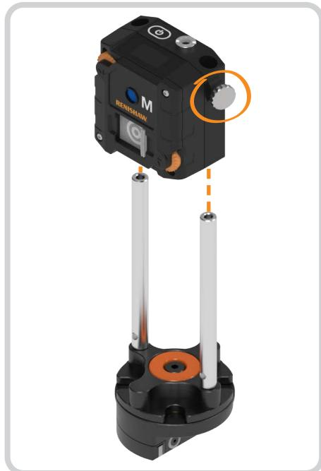
将安装杆拧入旋转头上的安装孔内。
