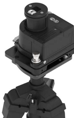
将发射器吸附在三脚架平移云台上。
