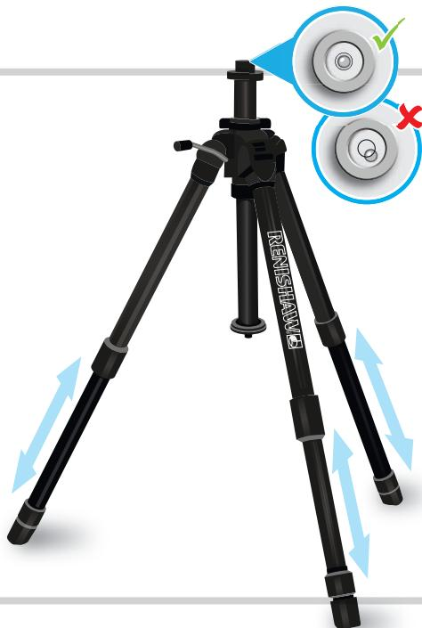
**注:** 仅在无法将发射器固定到机器结构上适当位置的情况下才使用三脚架。发射器是参考基准,因此三脚架不稳定会影响测试精度。
