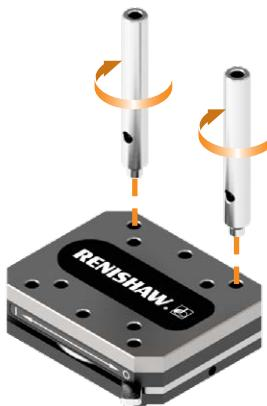
将安装杆拧入薄型磁力座上。
