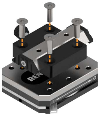
利用四个内孔，用螺钉将五棱镜平移台
