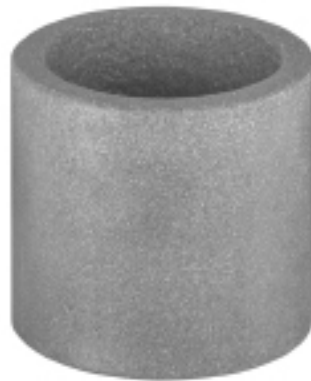
그림 1 표면 마감 거칠기가 16 Ra인 실리콘 카바이드 시험편.
