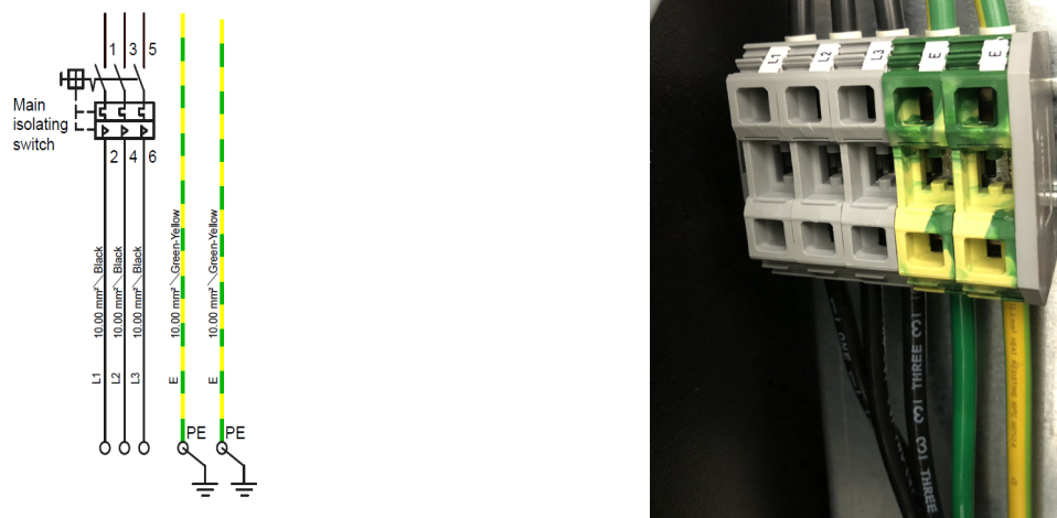
Figure 69 Schéma de câblage (à gauche) et bornier (à droite) du système RenAM
