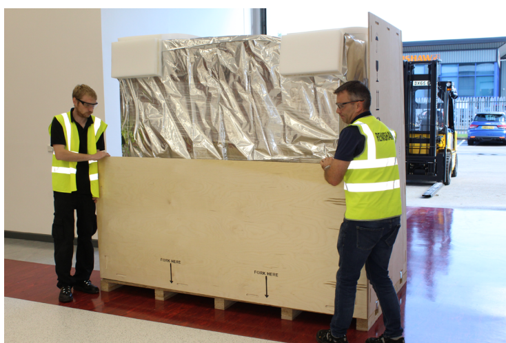
Figure 54 Retrait du panneau inférieur arrière
