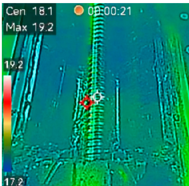
圖 3：室溫狀態下工具機的热圖像（熱成像圖）清楚顯示，這時滾珠螺桿的溫度與工具機的整体溫度基本一致。
