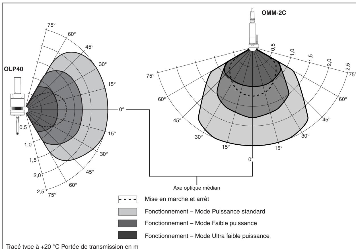
Tracé type à +20 °C Portée de transmission en m
