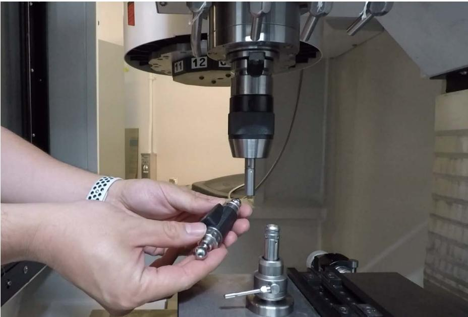
Autodesk邀请雷尼绍协助其旧金山技术中心使用QC20球杆仪检测机床精度。球杆仪测试是一种快速检测数控机床定位性能的方法，有助于对机床状况进行基准测试与长期跟踪。利用球杆仪采集的数据，可以按照国际机床性能标准（ISO 230-4和ANSI/ASME B5.54），对机床的定位精度（圆度、圆度偏差）进行全面的计算分析。
