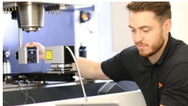
由於 XM-60 的單一線性軸量測可同時量測並解析 6 個自由度誤差，有別於傳統量測方法，測試結果可立即在 CARTO 軟體整合，根據 ISO 標準規範如 ISO 10791-2 (2023) 等進行誤差分析及比對，並生成客製化的報告，方便分享。尤為值得一提的是，XM-60 能夠按照最新 ISO 標準要求，自動生成量測不確定性報告。這一功能不僅大幅提升了量測結果判定的可靠性，還降低了對操作人員技術能力的要求。
