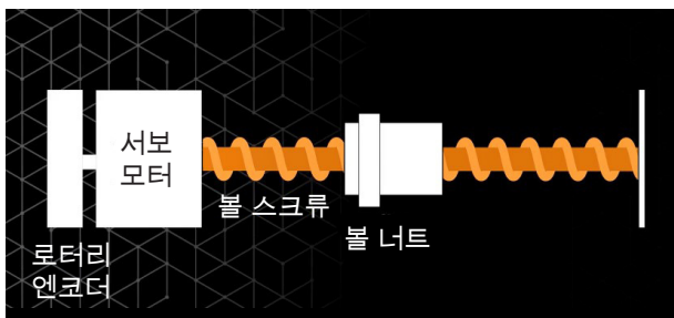
그림 1: 세미 클로즈 공작 기계 서보 루프에 사용되는 주요 구성품.
