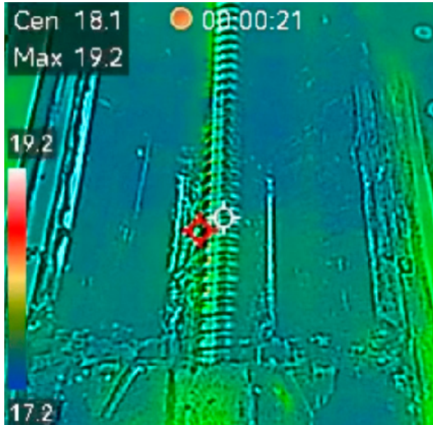
그림 3: 이 열 이미지(열화상)은 실온의 기계를 보여줍니다. 볼 스크류의 온도가 기계의 주변의 온도와 거의 같다는 것을 확인할 수 있습니다.
