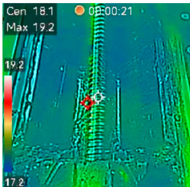
図 3: 室温での熱画像。ボールねじの温度が周囲温度とほぼ同じでなのは明らかである。
