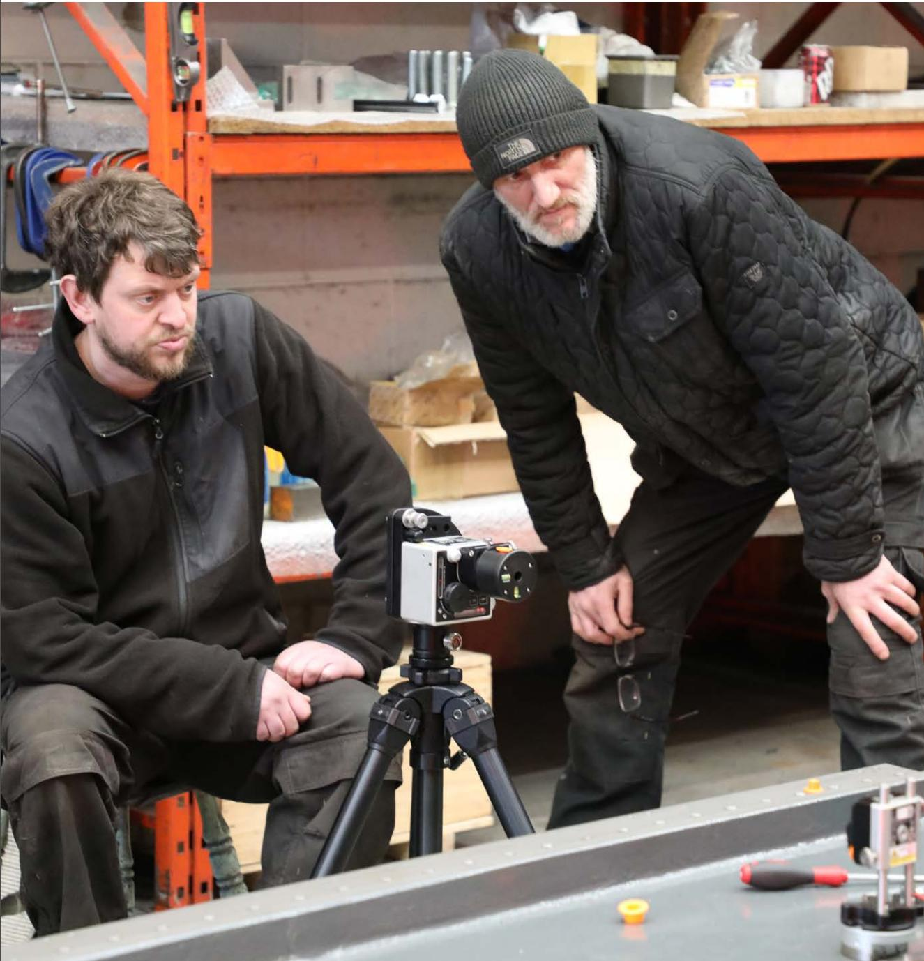
XK10激光校准仪大幅简化了HNC的机床校准流程。“在使用XK10激光校准仪之前，我们使用望远镜采集读数并手动绘制图表，一组数据需要花上四个小时左右，”Mike Diskin说道。“如今我们只需要大约20分钟就能得到一组读数，并将图表打印出来。”
