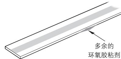
7. 静置24小时，待环氧胶粘剂完全固化后，用雷尼绍栅尺擦拭布或干净、干燥的无绒布清洁栅尺。
