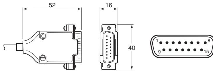
20针FANUC连接器（终端代码H）
