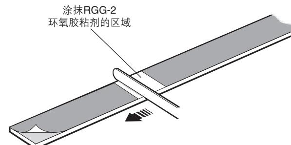
5. 使栅尺贴紧定位销或定位台阶，并向下旋转固定到基体上。用手指用力按压。
