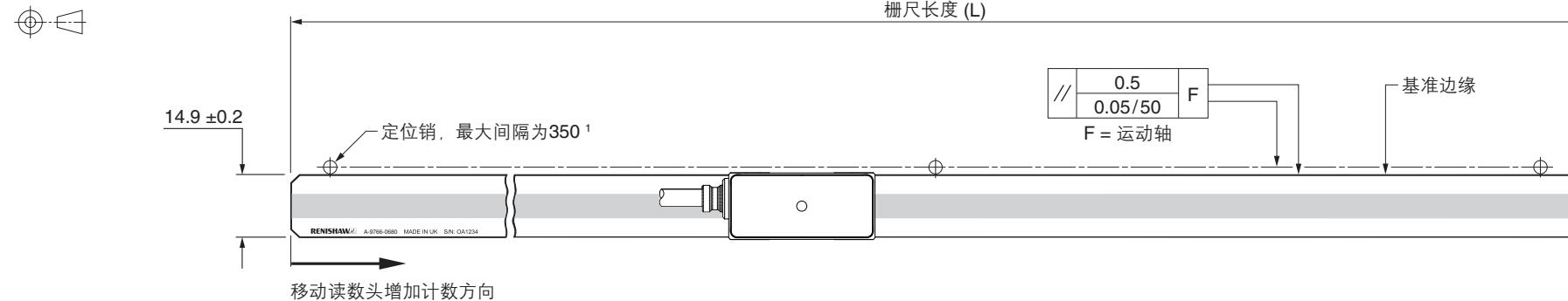
注: 读数头可安装在任一方向。光栅计数方向仅取决于栅尺方向。
