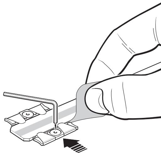
4. 将基准夹具安装到栅尺上，并用随附的专用M3扁平头螺钉固定到位。
