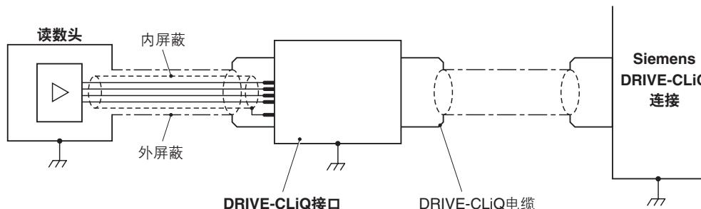
**重要提示:** 如果重新端接双屏蔽读数头电缆，必须确保内屏蔽和外屏蔽彼此绝缘。如果内屏蔽和外屏蔽连接到一起，将会造成0 V针脚和地线之间短路，从而导致电子干扰问题。
