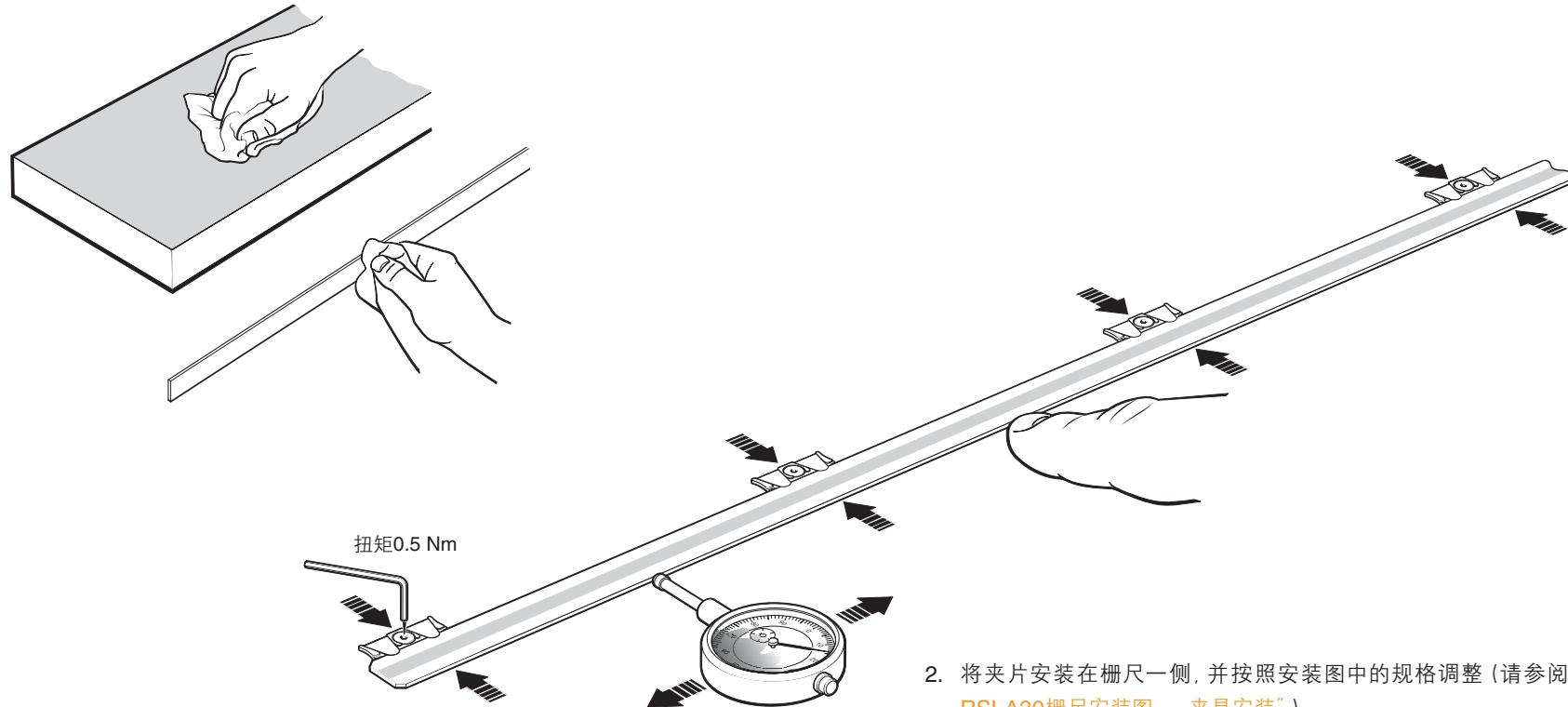
2. 将夹片安装在栅尺一侧，并按照安装图中的规格调整 (请参阅第14页的“[RELA30/RSLA30栅尺安装图 — 夹具安装](#)” )。
