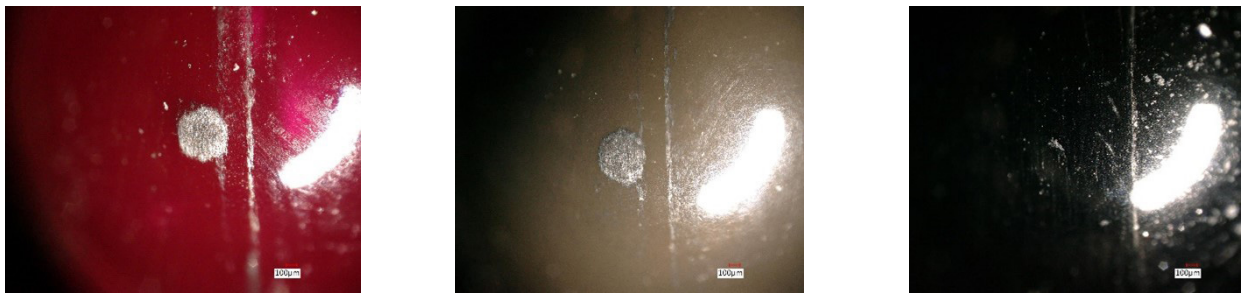
圖 2. 測試完成後測球的顯微照片（1－紅寶石測球，2－氮化矽測，3－OPTiMUM 鑽石塗層測球）。
