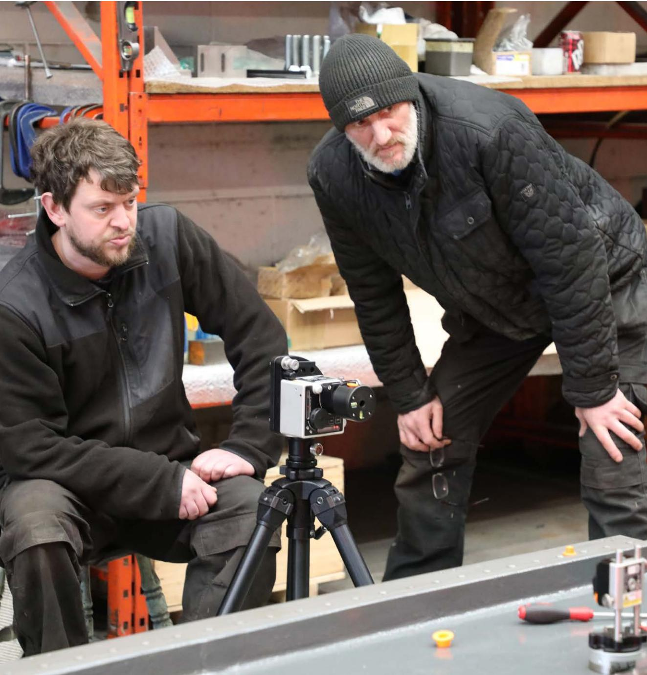
XK10 雷射校準系統大幅簡化了 HNC 的工具機校正流程。「在使用 XK10 雷射校準系統之前，我們使用望遠鏡採集讀數並手動繪製圖表，一組資料需要花上四個小時左右，」Mike Diskin 說道。「如今我們只需要大約 20 分鐘就能得到一組讀數，並將圖表列印出來。」
