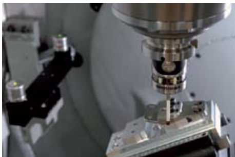
レニショーの非接触式レーザー工具測定システムとワークセットアップをするOMP40 タッチプローブ
