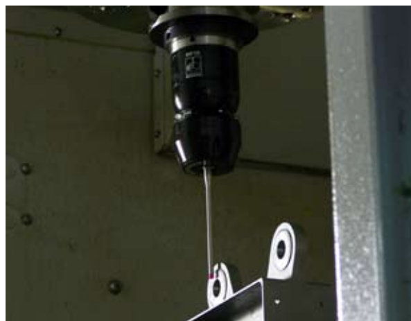
Natančnost obdelovanca se med procesom kontrolira z merilno glavo...
