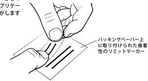
▶ 図のように、スケール上の必要な場所にインクリメンタルトラックに沿ってマーカーを位置合わせし、スケールにマーカーが貼り付くまでアプリケーターフィルムを強く押
