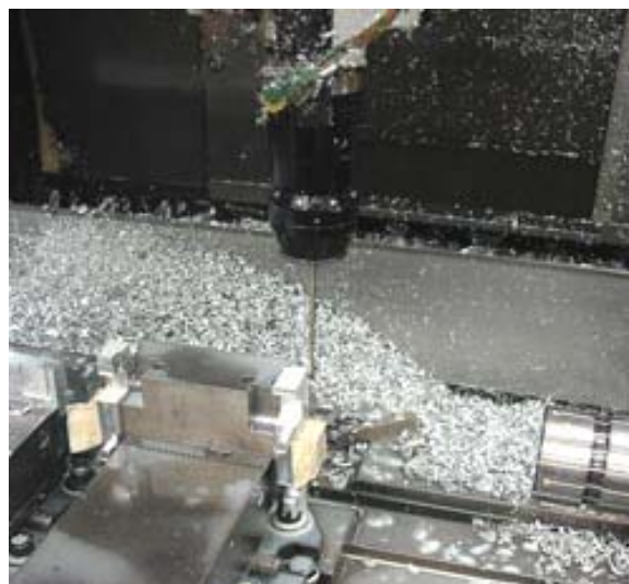
Vřetenová sonda MP10 při ustavování dílce pro další obráběcí operace.
