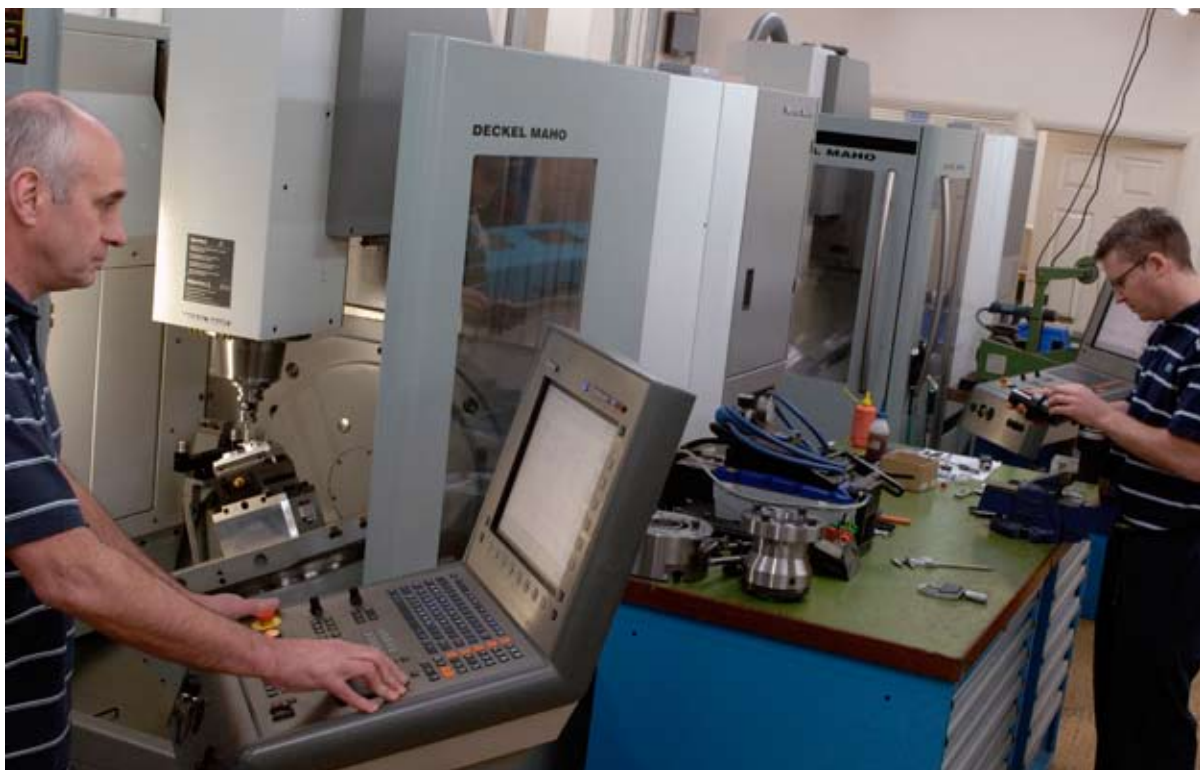
Werkstukken worden op kleine pallets in de DMG DMU-50 machines geplaatst. Het gereedschap moet vaak gewisseld worden
