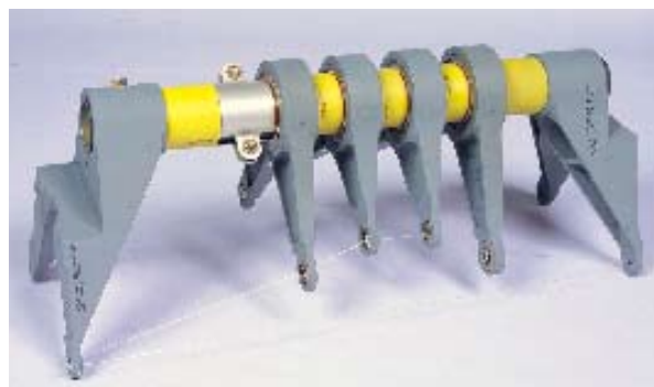
Typická práce firmy Alp pro Sikorsky - obrobení součástí a montáž do zobrazené fáze
