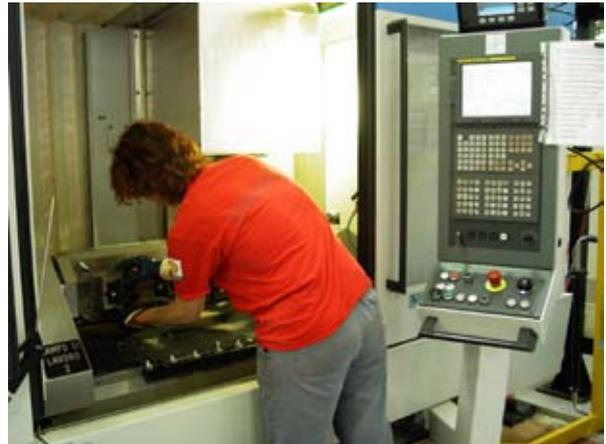
オペレーターはワークをセットし、すべてがスムーズに作動していることを確認するだけで、一人のオペレータが簡単に2台の機械を管理できます。
