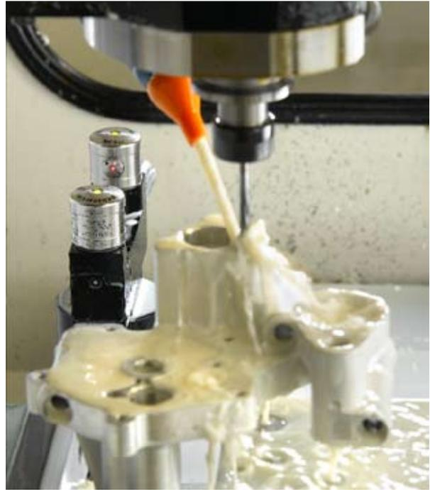
工具折損により引き起こされる非常に高価なパーツへのダメージを回避するために、レニショーのNC4システムを使用し、スクラップ、再加工、および時間の無駄を排除しています。
