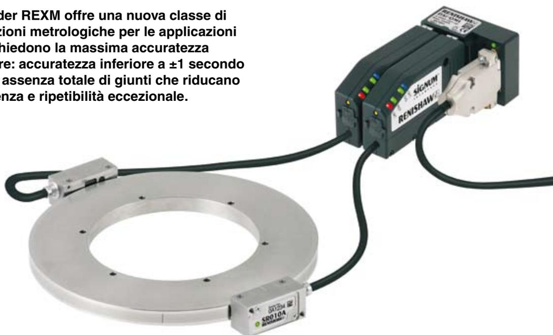
Come l'encoder RESM, l'anello REXM è realizzato in acciaio inossidabile, con la traccia incisa direttamente sulla periferia, con uno spessore radiale aumentato per ridurre al minimo gli errori d'installazione, a esclusione dell'eccentricità.
