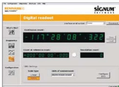
Todos los encóderes **SiGNUM**™ de Renishaw se conectan al PC mediante el puerto USB, donde el completo software **SiGNUM**™ permite realizar un reglaje óptimo y diagnósticos del sistema en tiempo real, incluso bajo control de bucle de servo completo. La interfaz Si-FN incluye un DRO (lector digital de cotas) completamente funcional para otros diagnósticos.
