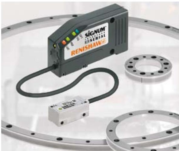
Las interfaces Si-FN se distribuyen en tres opciones de resolución. 'Normal' es la resolución de 20 bits (0,0003 grados) con una velocidad máxima de 4.500 r.p.m.; 'High Type A' tiene una resolución de 23 bits (0,000043 grados), mientras que las interfaces 'High Type B', con una resolución de hasta 26 bits (0,0000054 grados), proporcionan la máxima precisión sin bajar de 600 r.p.m.
