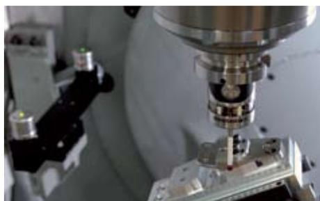
Posicionador de ferramentas a laser sem contacto da Renishaw e sonda de contacto OMP40 para posicionamento das peças de trabalho
