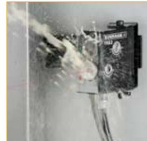
TRS2: sistema de detección de rotura de herramientas
