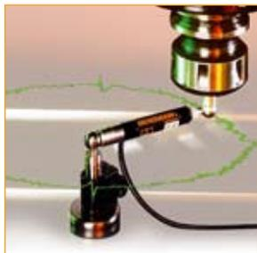
**Ballbar QC10: rápida comprobación del rendimiento de la máquina herramienta**
