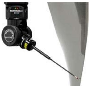
REVO™五轴测座的成功关键在于，它能够克服三轴扫描方式的局限。在三轴扫描中，快速移动较大的CMM主体结构可导致因加速和减速而造成的惯性误差。因此，在三轴扫描中若想实现较高的精度，惟一可行的办法是必须降低测量速度。然而，REVO™在扫描过程中使测座和机器同步移动，能够快速跟踪零件几何形状的变化，而又不会引入自身的动态误差。CMM在测量过程中能够以恒定的速度移动，对精度不会造成任何影响。
