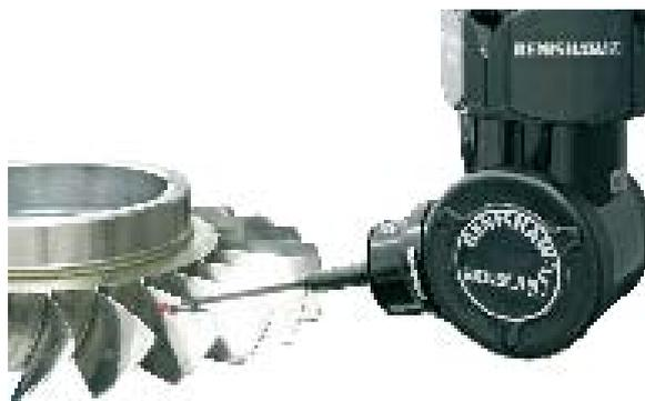
第一项应用是测量航空发动机的叶盘，需要对机翼轮廓进行9次断面扫描，在叶片上进行8次纵向扫描，对焊缝根部轮廓进行两次扫描，最后在内齿轮断面上进行一次扫描。以前利用三轴扫描系统进行测量时，一个机翼就要花上46分钟，而用REVO™系统只需4分30秒，效率提高了922%。
