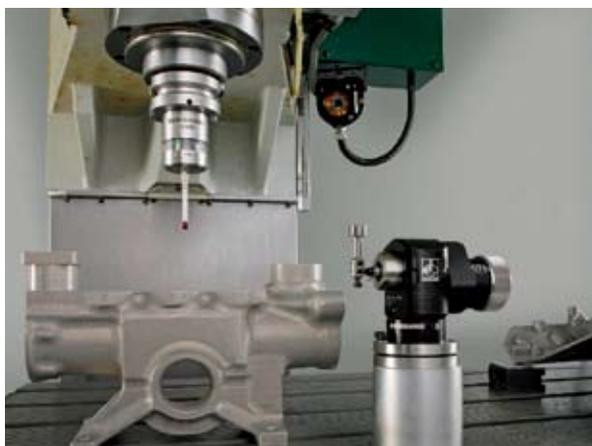
一个典型的双测头系统由Renishaw新型OTS对刀测头和Renishaw OMP40-2工件检测测头组成，但也可使用其他兼容的采用调制光学传输方式的Renishaw触发式工件测头。无线对刀测头的设计特别适用于具有交换工作台或旋转工作台的机器，而且这些机器已经证实可以安装硬线连接的对刀测头。
