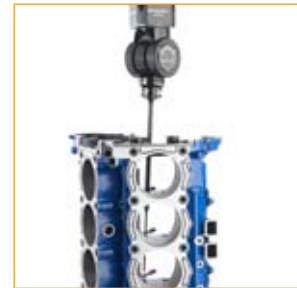
REVO™ – system głowicy pomiarowo-skanującej z napędem
