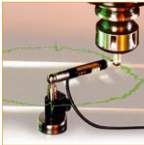
QC10 ballbar – szybka ocena stanu technicznego obrabiarek
