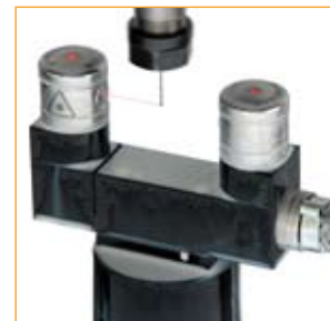
NC4 Compact – bezdotykowe, laserowe ustawianie narzędzi
