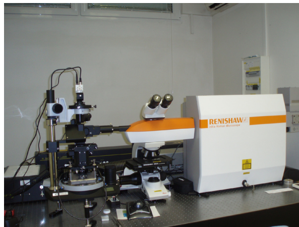
Unikátní instalace Ramanova spektrometru Renishaw na Fyzikálním ústavu Akademie věd České republiky.
