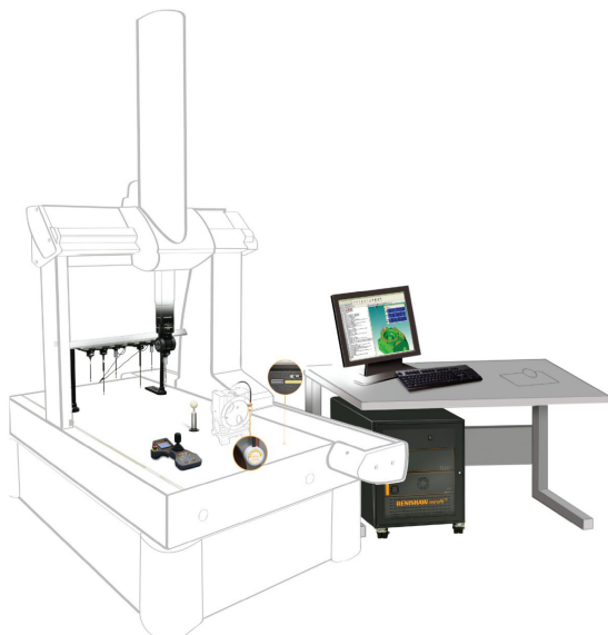
Elementi di un retrofit su una macchina di misura – tastatore, testa, righe ottiche, controllo e software
