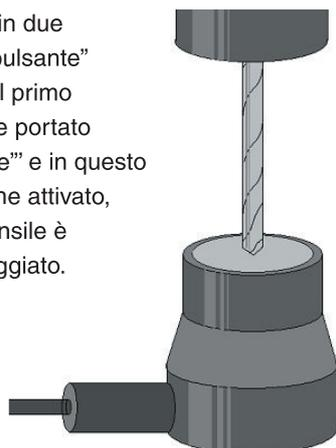
Il sistema ad astina consiste di un attuatore che fa ruotare un'asta fino a portarla a contatto con l'utensile. Se il contatto non si verifica, il sistema interpreta l'evento come una rottura utensile.
