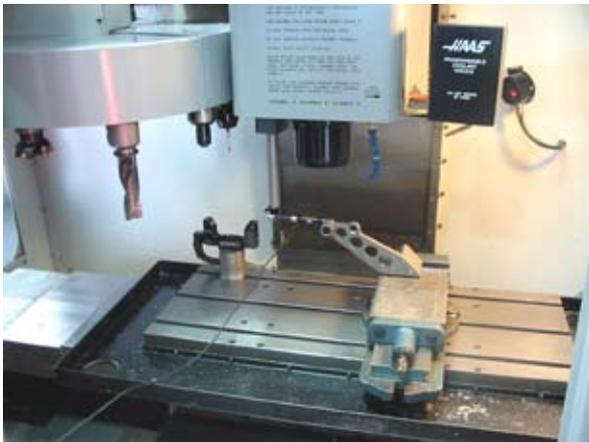
Ballbar QC10 contrôlant la performance de positionnement sur un centre d'usinage vertical HAAS
