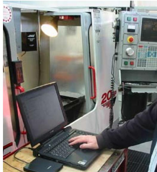
À l'issue du test ballbar, des ajustements peuvent être effectués et la machine retestée pour disposer d'une référence d'analyse continue dans l'historique des performances de positionnement et permettre une maintenance préventive.
