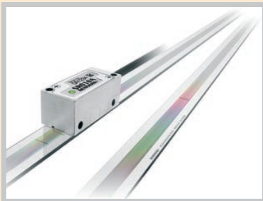
RELM高精度リニアスケールが**SIGNUM™** シリーズの中に、新しく加わりました。1.4 μm/m/Kという低い熱膨張率を持つインバーで、20 μmのRELMスケールは、固定長で提供され、**IN-TRAC™** リファレンスマークの位置を選択できます。堅牢性を持ち尚且つ精度が高いスケールによって、以前はよりデリケートなファインピッチエンコーダシステムからのみ使用可能であった水準のパフォーマンスが得られるようになります。±1 μmの精度および20 nmの分解能によって、RELMは非常に高い精密度が要求されるモーション要件を満たします。
