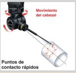
Para una serie de puntos alrededor de un orificio, los ejes del cabezal giran hasta la posición necesaria y después el palpador se desplaza un poco hacia fuera, tomando los puntos necesarios.
