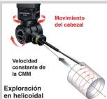
Esta novedosa técnica puede utilizarse también para tomar puntos muy rápidos en superficies planas y de forma libre. Los ejes de la máquina guían el cabezal paralelo a la superficie y la sonda de "detección de la punta" baja para tomar puntos sin que la máquina disminuya su velocidad normal (aunque la exploración normal podría realizarse mucho más rápido en muchas aplicaciones.
