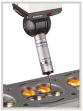
Sonda de exploración indexable de alta precisión SP25M
