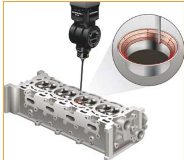
Esta última exploración emplea la potente capacidad de exploración adaptable de REVO®, que con un solo comando de exploración permite cubrir las áreas por encima y por debajo de las superficies críticas del asiento de válvula.
