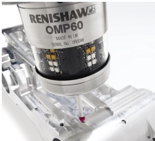
本产品使用市场上广泛销售的AA电池，大大方便了用户的使用。若OMP60使用锂电池，可延长使用寿命，其经济性居于行业领先地位。测头在正常使用时，电池可使用6个月以上，极大降低了机床停机时间和维护费用。用户可编程参数提供了多种开启/关闭选项，可方便地对OMP60进行性能优化，以适合实际应用的需要。用户可通过Renishaw成熟的触发逻辑对该测头编程。利用这种独特而简单的方法，无需拆开测头就能对测头选项编程，从而避免了因冷却剂和碎屑污染而造成的损坏。
