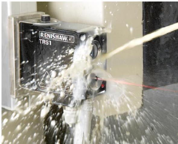
這個識別過程確保能够在加工循環的開始或結束時快速地檢測各個刀具。
