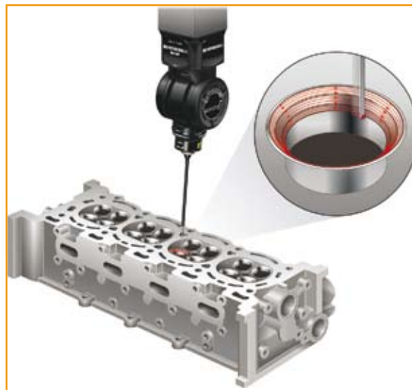
REVO® při skenování sedel válců na bloku motoru
