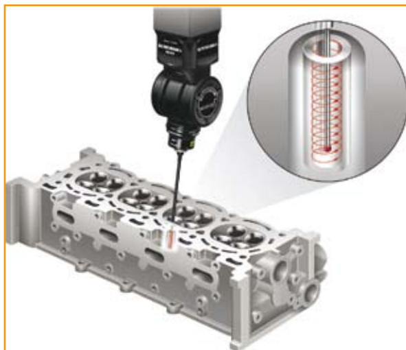
REVO® při skenování ventilů na bloku motoru
