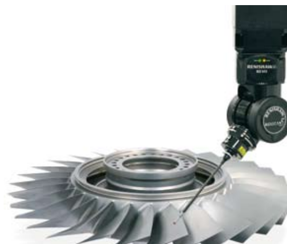
Vysoce rychlý 5-ti osý systém REVO měřící lopatkovou hřídel.
