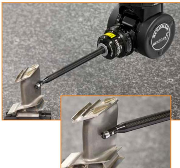
L'asse C consente di orientare la punta della sonda su qualsiasi angolo necessario per l'ispezione del pezzo.
