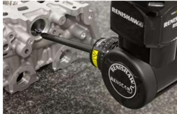
La SFP1 se suministra con dos soportes para palpadores especiales, el palpador recto SFS-1 y el palpador acodado SFS-2, instalados sobre el sistema de rack modular (MRS) del sistema REVO®. La selección del palpador se realiza desde el programa de medición, esto flexibiliza el acceso a los elementos a medir en la pieza, con la fiabilidad de una metodología CNC totalmente automatizada.
