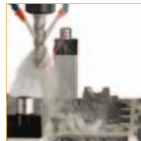
Bezdotykowy, laserowy system NC4, o wysokiej szybkości działania, jest dostępny w postaci związanej lub rozdzielonej
