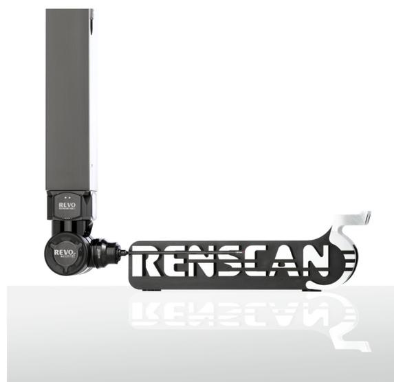
A differenza degli stili tradizionali, che devono essere necessariamente molto rigidi, il nuovo stilo cavo è stato progettato per essere in grado di flettersi, producendo in tal modo una deflessione del fascio laser di ritorno che viene monitorata da un rilevatore di posizione (PSD), anche esso montato nel corpo della sonda.
