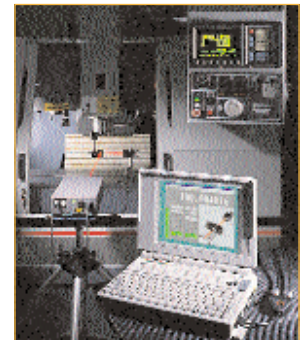
Wzorcowanie liniowej osi obrabiarki za pomocą laserowego systemu pomiarowego.
