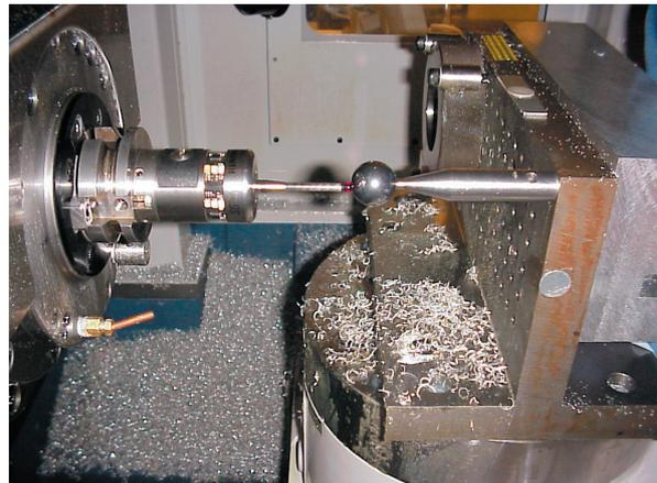
Gracias a su reducido tamaño, la sonda puede instalarse en las máquinas más pequeñas para aprovechar las ventajas que proporciona la alta precisión de la tecnología de detección de esfuerzo. La sonda OMP400 es adecuada para máquinas con recorrido corto del eje Z y husillos tan reducidos como el HSK32.
