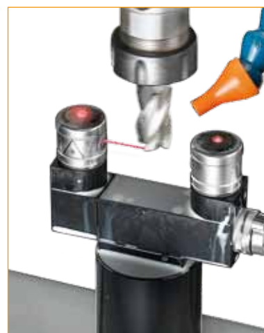
NC4 compact contrôlant si un outil est brisé
