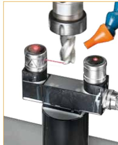
Kompaktes NC4 überprüft ein Werkzeug auf Bruch
