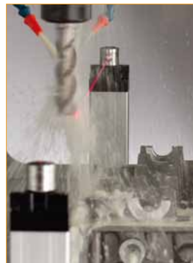
Laserowy układ NC4 wspomagający ustawianie narzędzi
