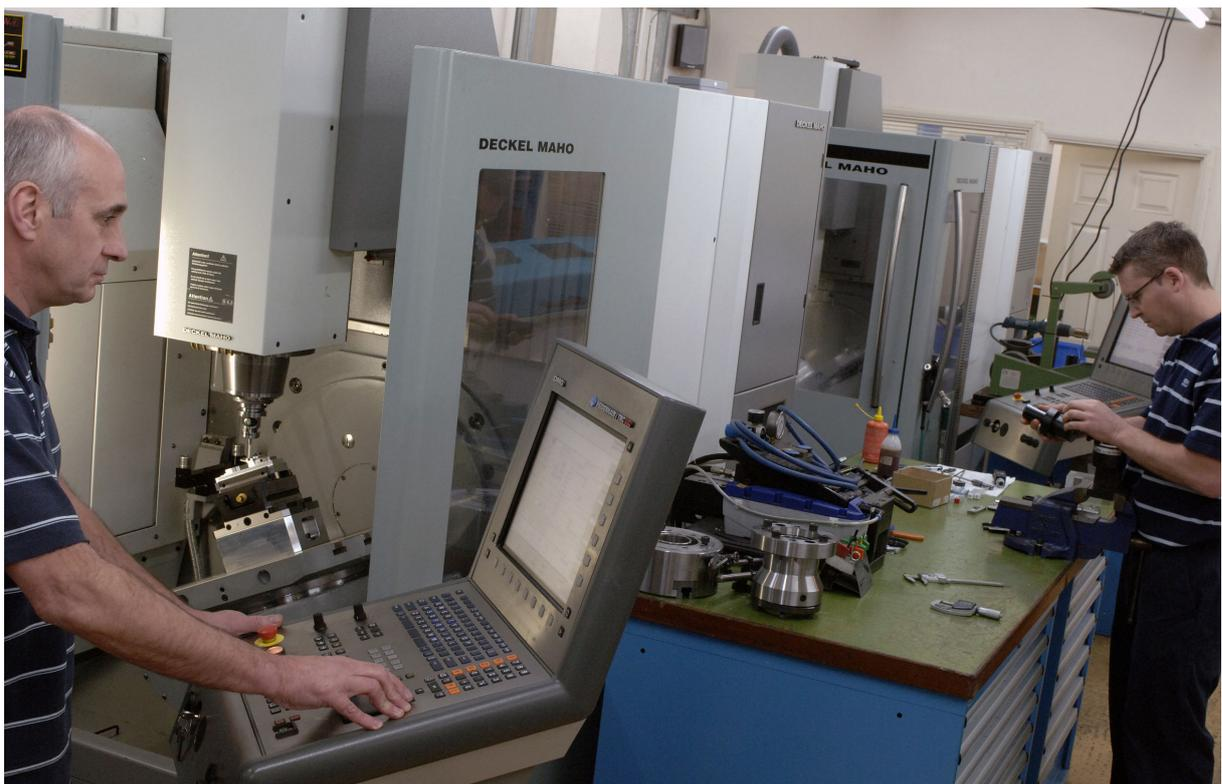
Aufträge werden auf kleinen Paletten in die DMU-50 Maschinen geladen und benötigen mehrere Werkzeugwechsel
