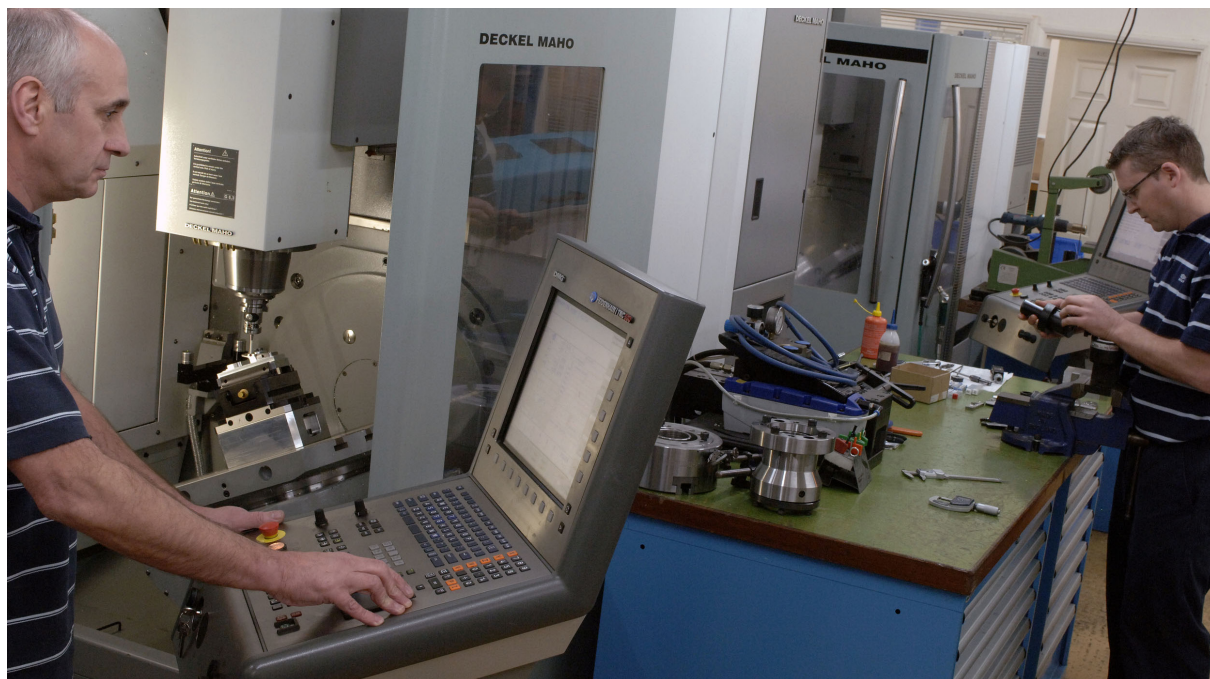
Przedmioty obrabiane tutaj się na obrabiarki DMG DMU-50 na małych paletach i konieczne są wielokrotne zmiany narzędzi
